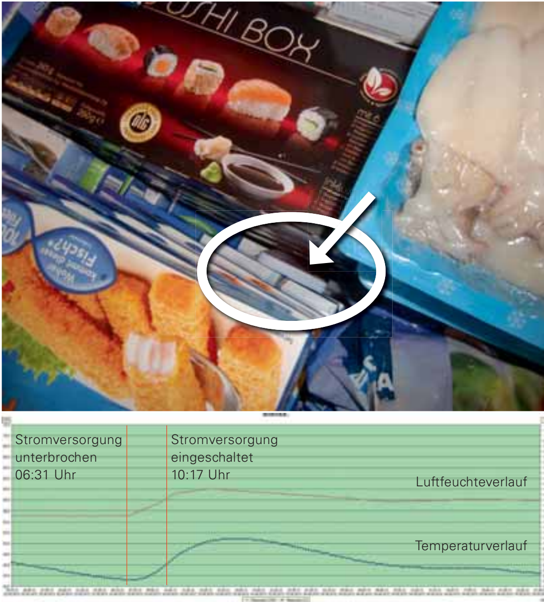
Abb. 65. Temp.-rel.-Luftfeuchteverlauf bei der AHT TK-Truhe
