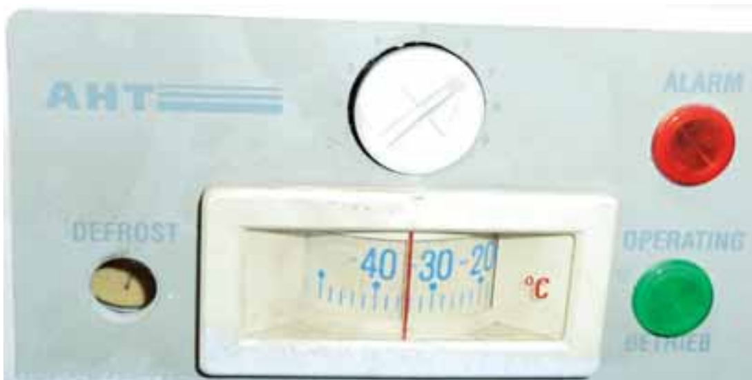
Abb. 38. TK-Truhe mit -34\text{ °C} eingestellt, keine Seltenheit
