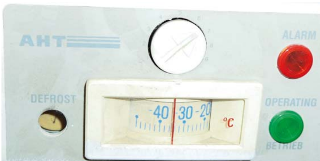
Abb. 38. TK-Truhe mit -34\text{ °C} eingestellt, keine Seltenheit
