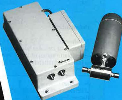
Durch die Kombination einer Dichtemeßzelle nach dem Paar Biegeschwingerprinzip und einem Schallgeschwindigkeitssensor ist die Bestimmung von Alkohol, Extrakt und Stammwürzegehalt
