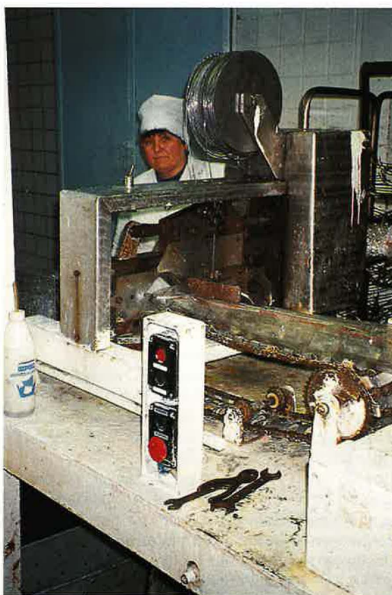
Herstellung von Wursthüllen aus Schlauchfolien.
