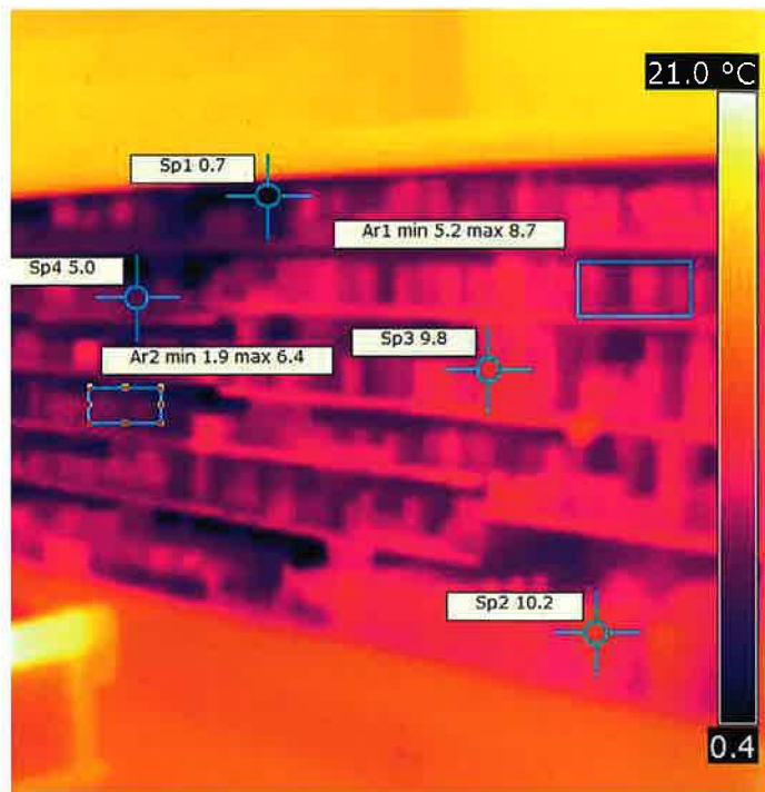
▲ Echtfarbenbild Kühlregal - Wärmebild Kühlregal / Colored picture refrigerated shelf - thermal picture refrigerated shelf
